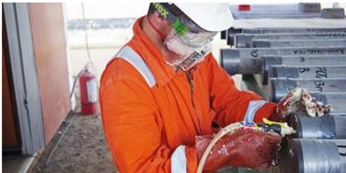
Figura 7. Estabilización mecánica con resina. Tomado de (ALSGLOBAL, 2017).
