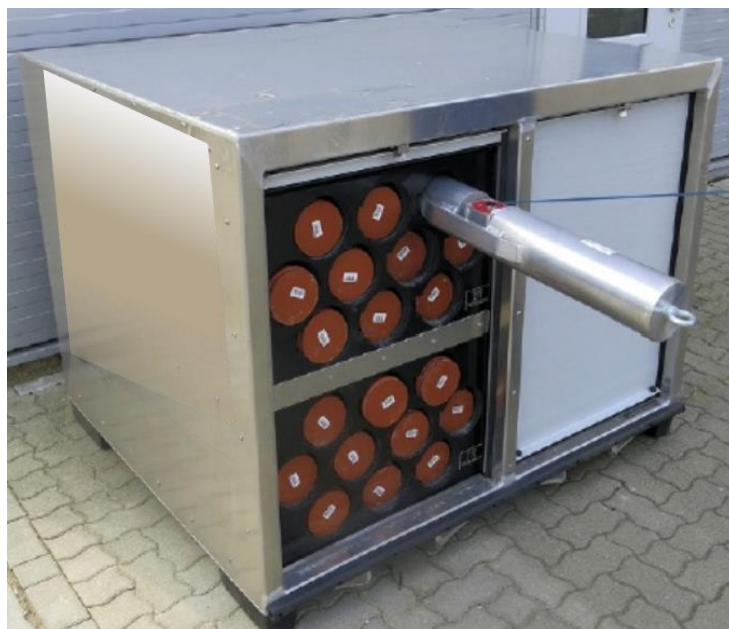
Figura 9. Nevera almacenamiento de núcleos preservados en mangas. Tomado de (McPhee, et al., 2015).
