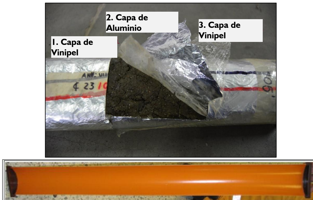
Figura 10. Metodología de preservación en PVC. Modificado de (Ariza & Buendia, 2010).
