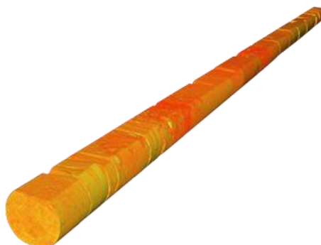
Figura 64. Escaneo del núcleo completo y segmentado para determinar las propiedades de porosidad y contenido mineralógico. (Software PerGeos).
